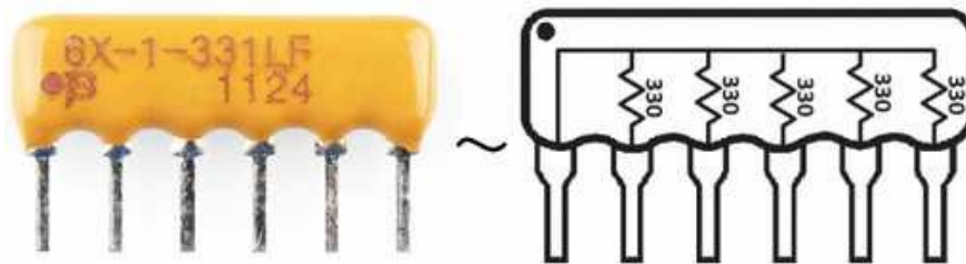
Un réseau de cinq résistances de 330 \Omega , toutes reliées ensemble à une extrémité.
